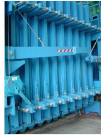
รูปที่ 3.5 แสดงลักษณะของ Battery Mould (Mould แนวตั้ง) ที่ควบคุมการทำงานด้วยไฟฟ้า
